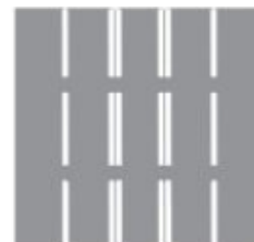
Marques longitudinals discontinues dobles
